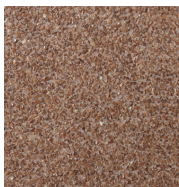
Ghiano Lavato -Pavimentazione passeggiata
